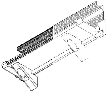
DEBOUCHER LE TROU SUPERIEUR DES CHARNIERES HAUTES AVEC UN FORET DE 4 PUIS LES TRACER AU MUR EN MEME TEMPS QUE LES TROUS DU PORTE-CARTES (2).
